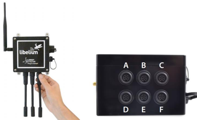
Figure 2 – Plateforme « Plug&Play » Libelium Gases PRO v2.0
