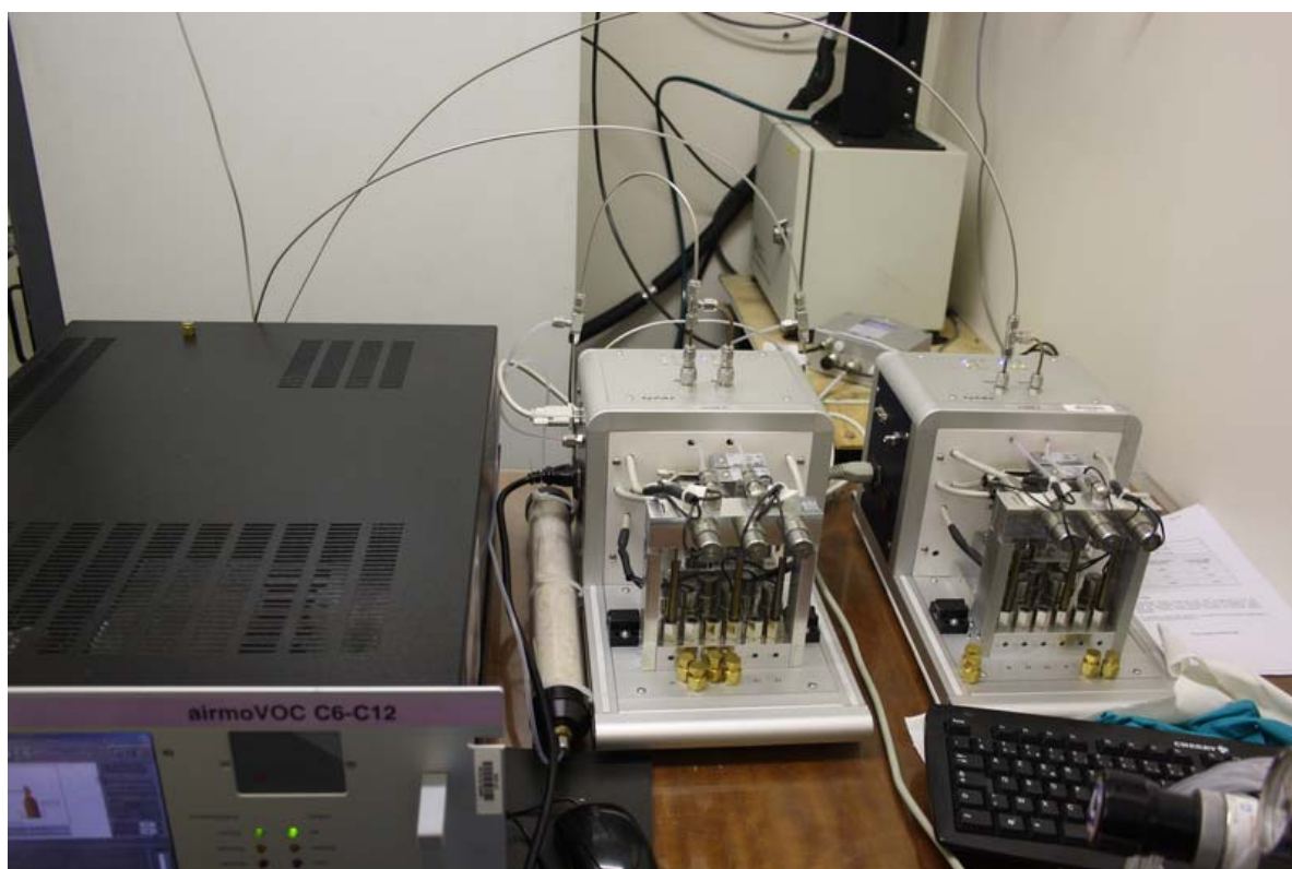
Figure 2.1 : les deux préleveurs (TERA Environnement) et l'analyseur automatique (Chromatotec) installés sur le site de MADININAIR
