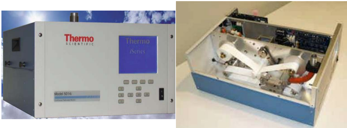
Figure 6 : (gauche) Vue extérieure du 5014i de Thermo Scientific. (droite) Vue intérieure du 5014i.
