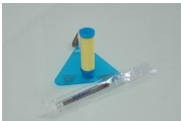
Figure 7 : Corps diffusif et cartouche code 145 d'un préleveur Radiello utilisé pour la mesure des composés organiques volatils
