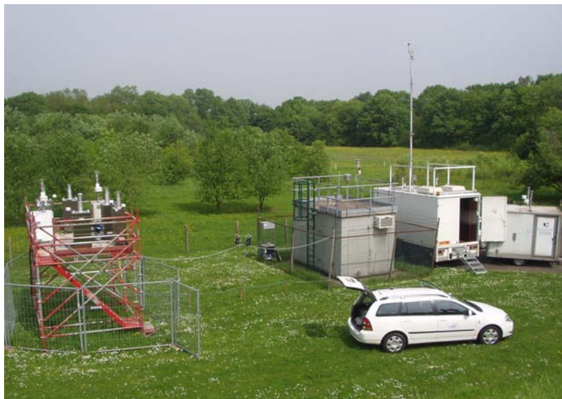
Figure 18. Vue d'ensemble des moyens mis en œuvre pour la campagne d'Aarschot (Jauges bêta LCSQA-EMD et références gravimétriques Leckel sur la plate-forme)
