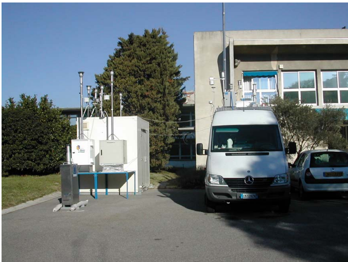
Figure 10. Vue d'ensemble des moyens mis en œuvre pour la campagne de Marseille (Jauges bêta en front, références gravimétriques dans l'abri autonome à l'arrière plan)
