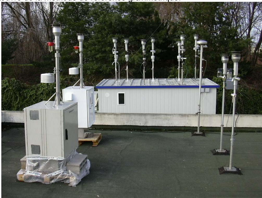
Figure 2. Vue d'ensemble des moyens mis en œuvre pour la campagne de Bobigny (Jauges bêta à gauche, TEOM d'Airparif à droite, références gravimétriques à l'arrière plan)
