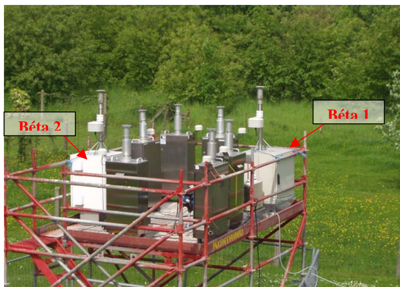
Figure 18 bis . Jauges bêta LCSQA-EMD et références gravimétriques Leckel sur la plate-forme d'Aarschot
