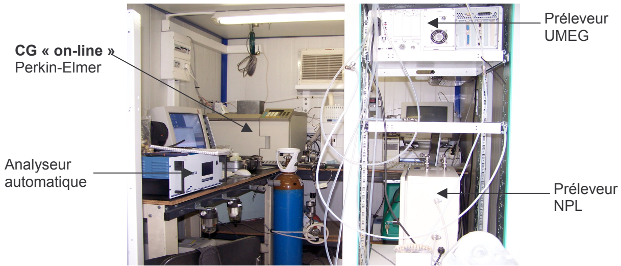
Figure 5-7 : Vue de l'intérieur de la remorque prêtée par AIRPARIF pour la campagne
