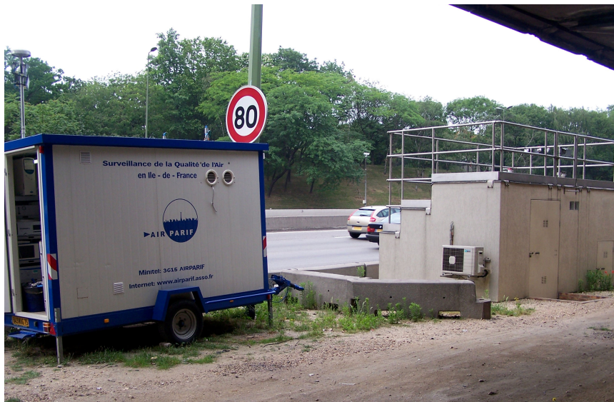
Figure 5-6 : Vue de la remorque (à gauche) prêtée par AIRPARIF pour la campagne et de la station de mesure permanente (à droite) du site d'Auteuil
