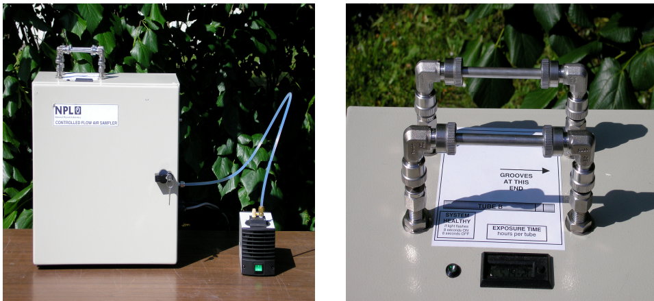
Figure 3-1 : Photographie de l'appareil de prélèvement Controlled Flow Air Sampler (CFAS) développé par le NPL (gauche) et zoom sur le système de deux tubes fonctionnant en alternance (droite).
