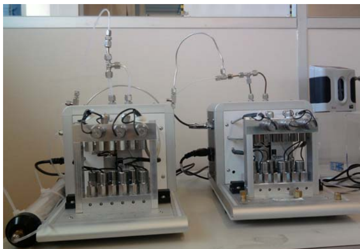
Figure 2.1 : les deux préleveurs TERA Environnement installés sur le site de l'Ecole des Mines de Douai
