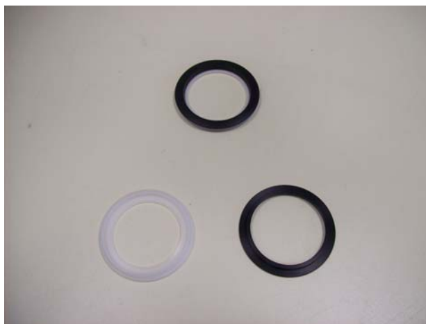
Figure 9 : Coupelle porte-filtre du FAI Hydra Dual Sampler (montée / démontée)
