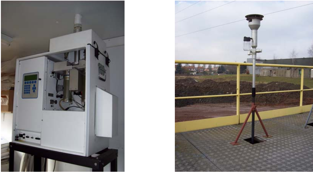
Figure 2: L'appareil Partisol Plus sur le site de mesure de l'EMD (intérieur & extérieur)
