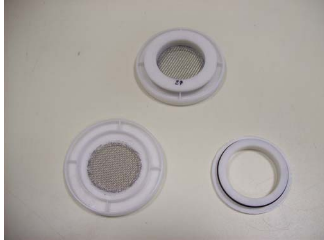
Figure 4 : Coupelle porte-filtre du LECKEL SEQ 47/50 (montée / démontée)
