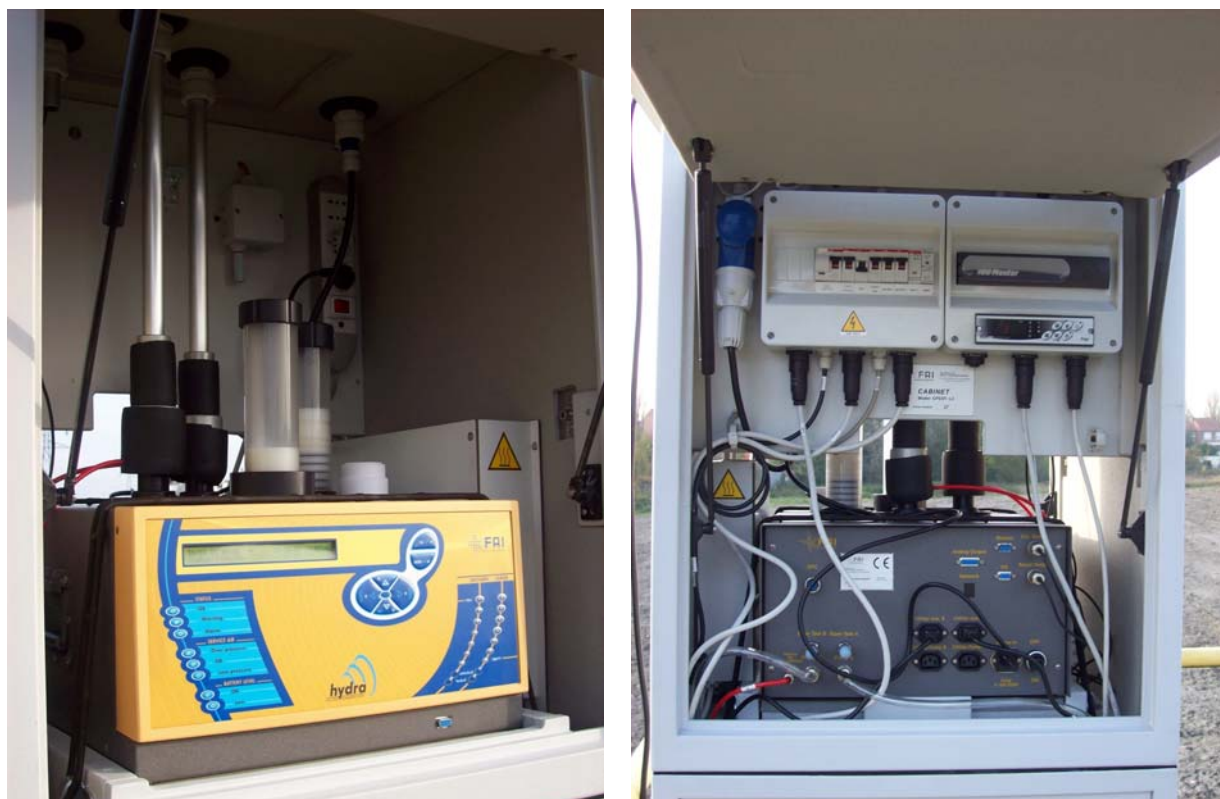
Figure 11 : faces avant et arrière du FAI Hydra Dual Sampler
