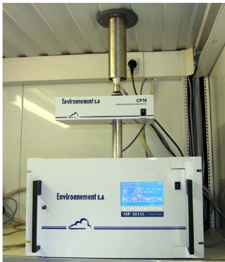
Figure 7: jauge radiométrique MP101M équipée d'un module CPM
