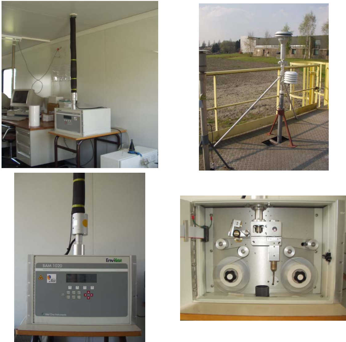
Figure 3: L'appareil BAM 1020 PM 2.5 de Met One sur le site de mesure de l'EMD (intérieur & extérieur)
