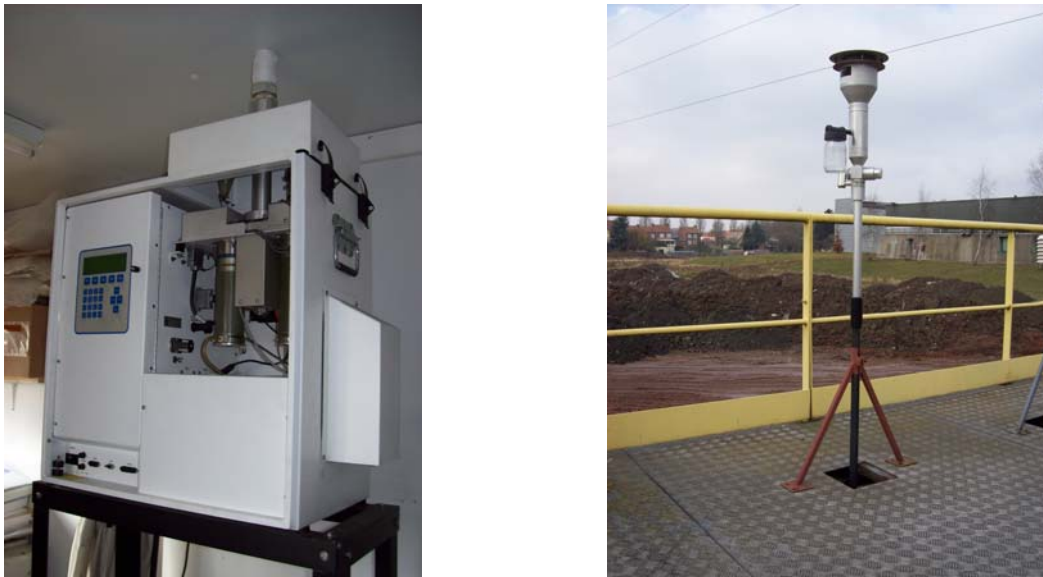
Figure 6: L'appareil Partisol Plus sur le site de mesure de l'EMD (intérieur & extérieur)
