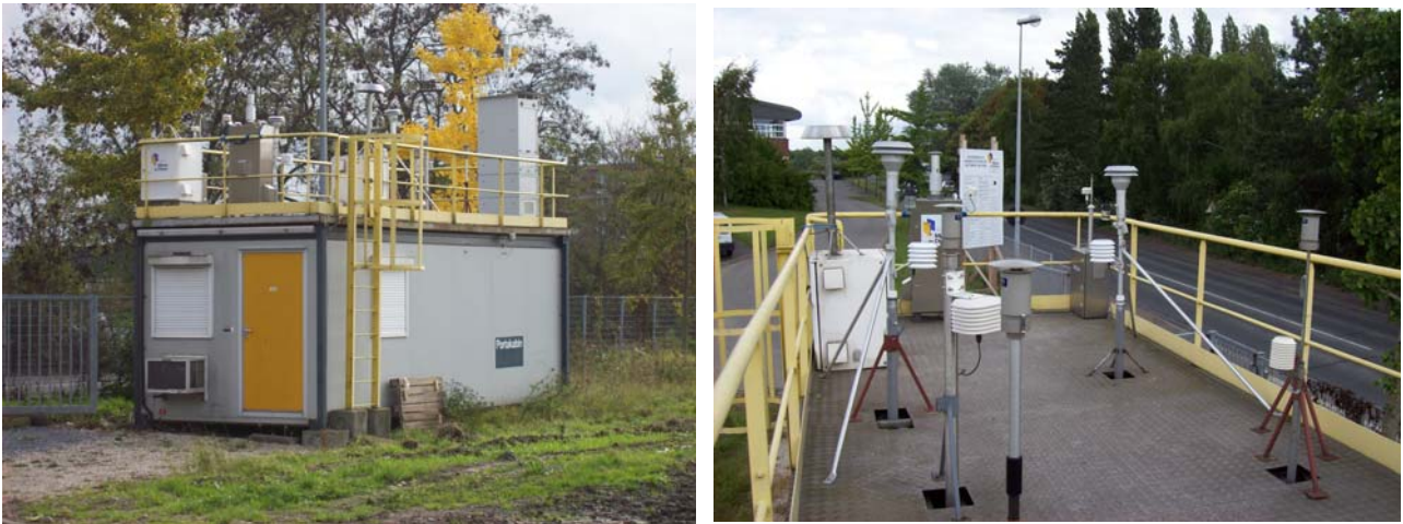
Figure 1: Vues (extérieur & intérieur) de l'abri autonome sur le site de mesure de l'EMD
