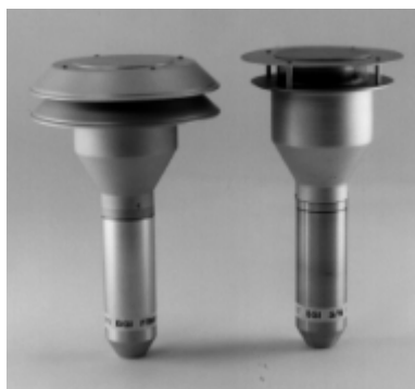
Figure 4: Têtes US PM 10 (« louvered » à gauche, « flat » à droite)
