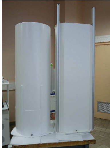
Figure 23 : Cloche de protection initiale (à gauche) et nouvelle cloche (à droite) livrée en août 2009
