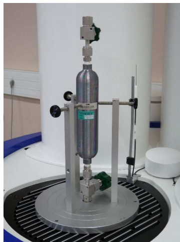
Figure 24 : Fixation des réservoirs en position de pesée
