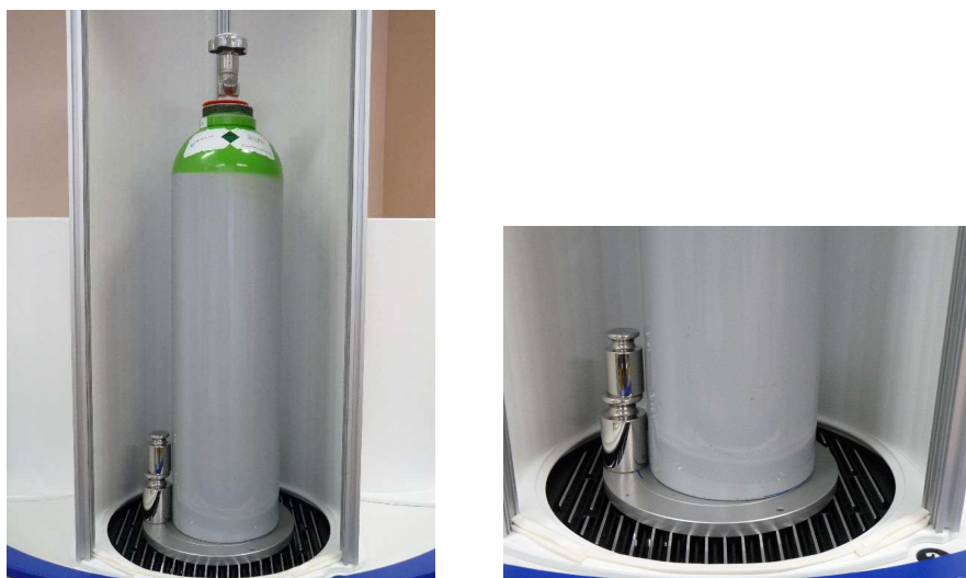
Figure 32 : Centrage de l'ensemble bouteille + étalons de masse sur le plateau de pesée
