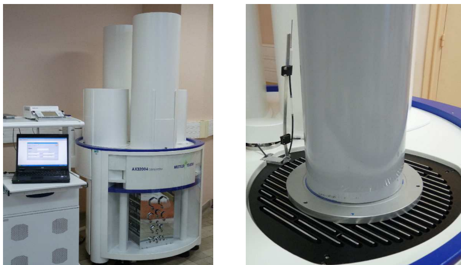
Figure 21 : Vue générale du comparateur de masse et du plateau de pesée
