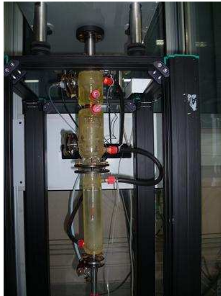
Figure 7 : Tube à perméation positionné dans la chambre en verre réglée en température
