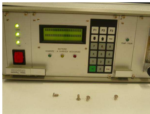
Figure 8 : Problème d'affichage du générateur Ansyco GEG 011
