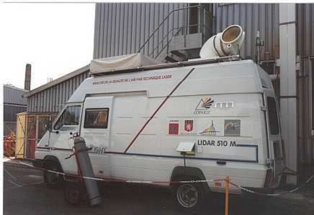
Vues du LIDAR COPARLY lors des campagnes d’évaluation Toluène et Benzène
