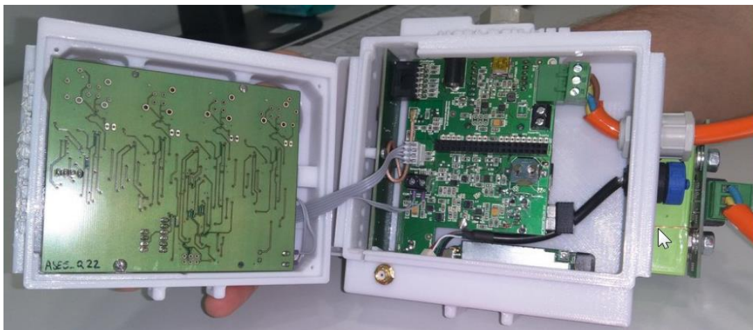
Figure 1: les deux cartes électroniques du boîtier AirSensEUR
