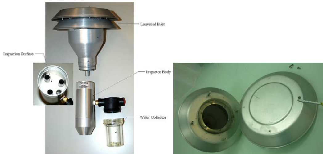
Figure 6 : Démontage de la tête PM 10
