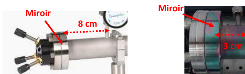
Figure 10 : a) Cellule telle que vendue par le fabricant (à gauche) ; b) Cellule après le déplacement de l'entrée et de la sortie du gaz (à droite)
