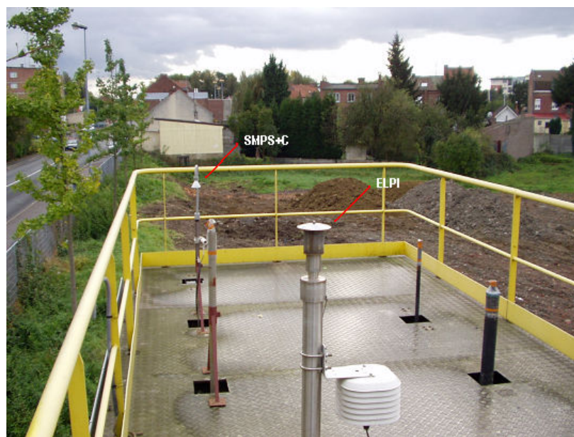
Photo 5.4 : Lignes d'échantillonnage des appareils en comparaison extérieure
