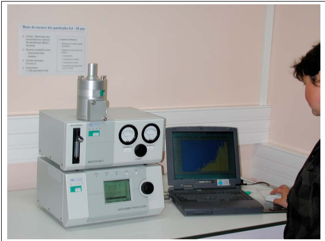
Figure 2 : Banc de mesures des grosses particules – classe granulométrique [0,5 – 20,0] µm.
