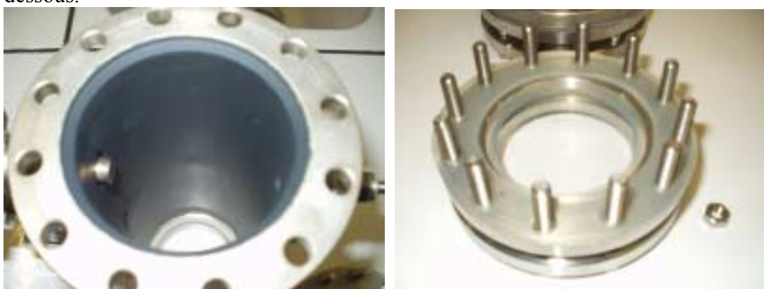
cellule scellée recouverte de Téflon noir dans sa partie interne, avec des joints en silicone et équipée d'un mesureur de pression digital
