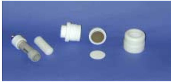
**Module d'échantillonnage assemblé dans le préleveur, et ses différents éléments**
