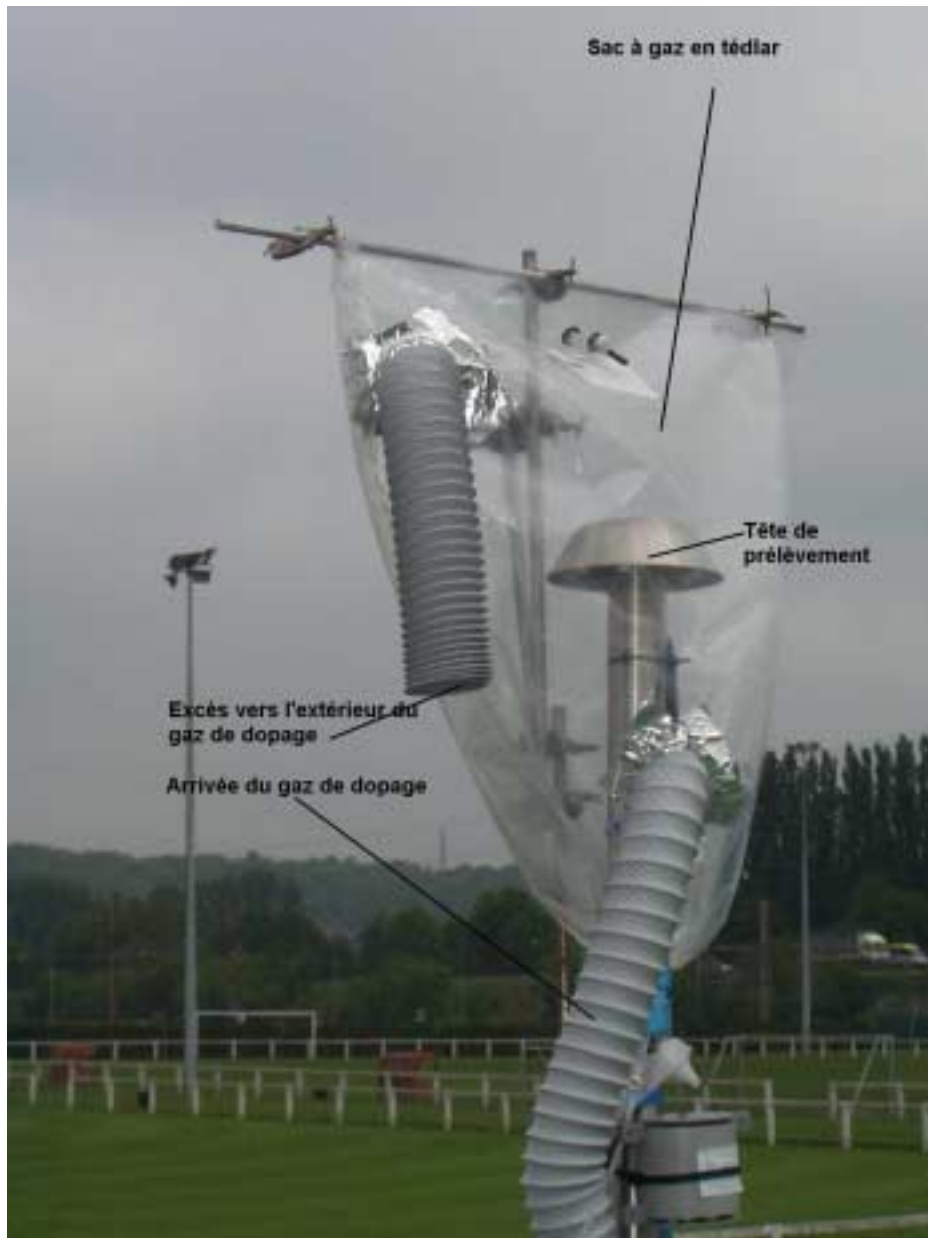
Photo 2.1 : détail du système de prélèvement au niveau de la tête de prélèvement de la station fixe.
