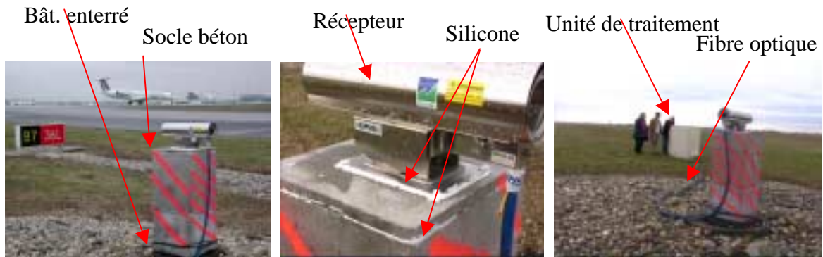
Aperçu du trajet optique et du socle du récepteur et de son unité de traitement
