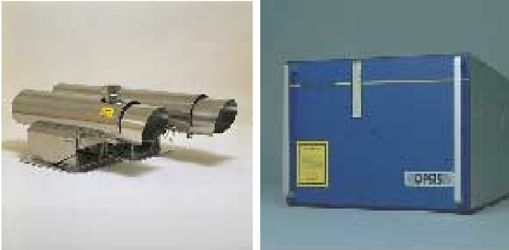
DOAS OPSIS : à gauche les unités d'émission et de réception, à droite l'unité de traitement.
