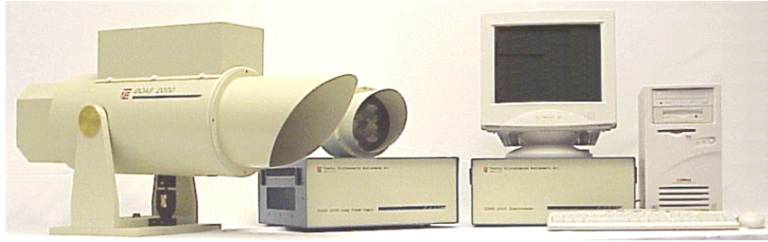
DOAS 2000 MEGATEC : à gauche l'unité d'émission/réception, au centre le rétro- réflecteur et à droite l'unité de traitement.
