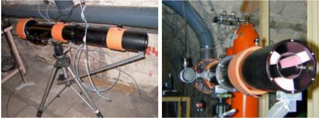
Figure 3 : les 2 cellules de 0,5 m chacune, montées sur le rétro réflecteur (au 1 er plan la face arrière du rétro réflecteur). Ce système est ici chauffé à 25°C (ceinture orange).
