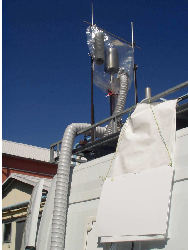
Figure 14 : boucle d'échantillonnage protégée du soleil par un écran opaque
