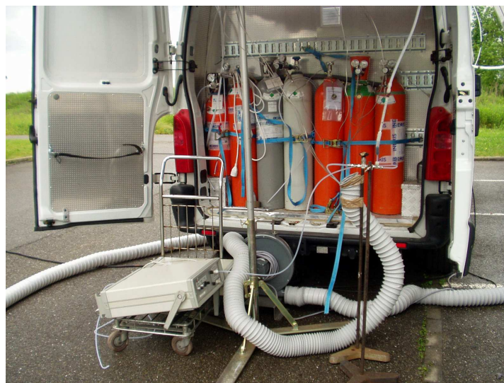
figure 5 : bouteilles « haute concentration » et générateur d'ozone haute concentration pour le dopage, bouteilles raccordées à la chaîne nationale d'étalonnage pour les réglages.
