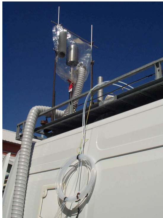
Figure 13 : ligne d'échantillonnage exposée à la chaleur et à un fort ensoleillement
