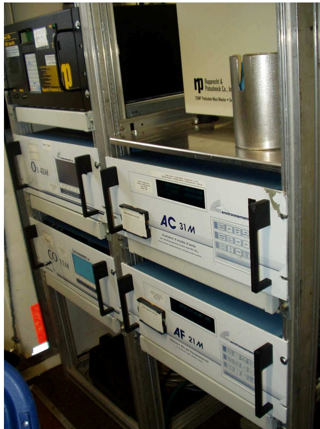
Figure 4 : analyseurs utilisés pour la comparaison à l'intérieur du véhicule.
