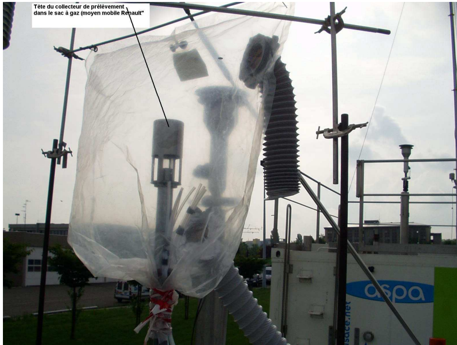
Figure 3 : Coiffage du système de prélèvement RENAULT
