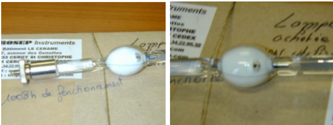
Détérioration de la lampe DOAS de l'émetteur, de type OGR, après 1008 h de fonctionnement.
