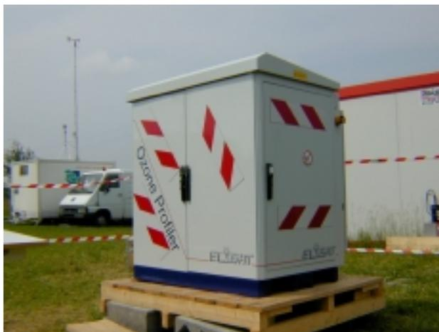
LIDAR Profiler d'Ozone vertical mis à disposition de l'INERIS pour la campagne INTERREG
