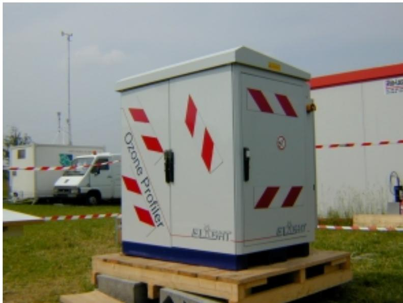
*Figure 3 : vue du LIDAR PROFILER D'Ozone vertical utilisé*
