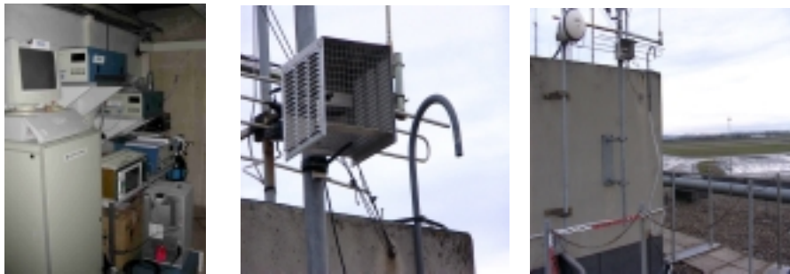
Unité d'analyseurs Tube passifs et ligne de prélèvement analyseurs
