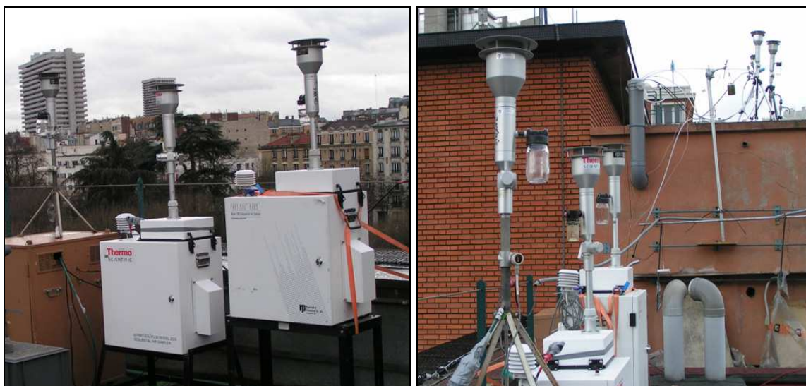
Figure 1 : Déploiement des préleveurs et du TEOM-FDMS sur le toit du LHVP au cours de la campagne d'hiver MEGAPOLI (janv.-fév. 2010).
