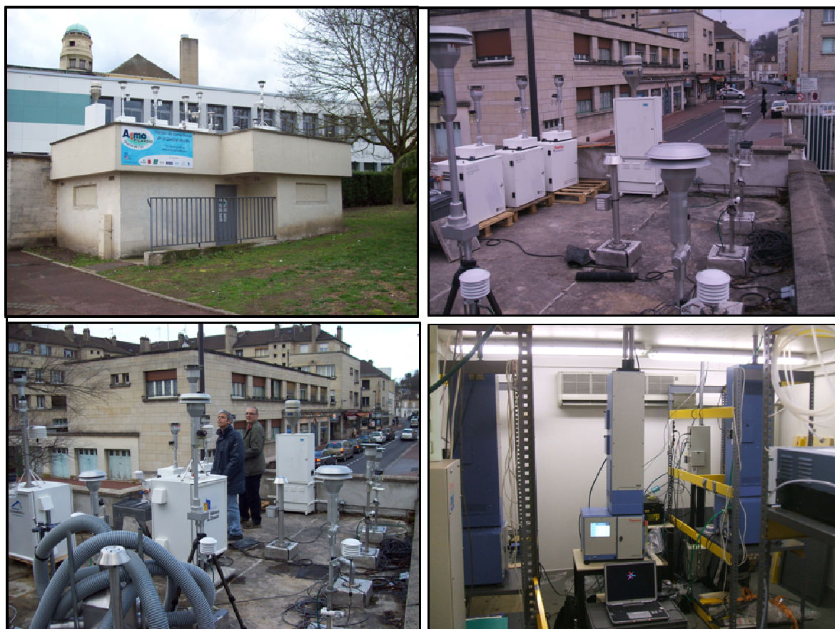
Figure 2 : Campagne 2010 d'évaluation des performances de mesure des TEOM-FDMS et jauges béta MP101M-RST à la station Creil-Faïencerie (printemps).
