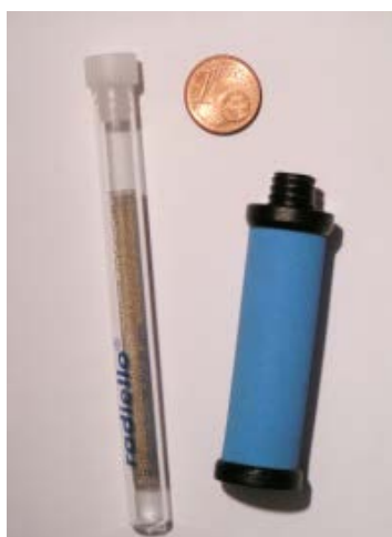
Figure 2. Photographie d'une tube Radiello® code 165 (gauche) et du corps diffusif dans lequel elle doit être introduite pour le prélèvement (droite)
