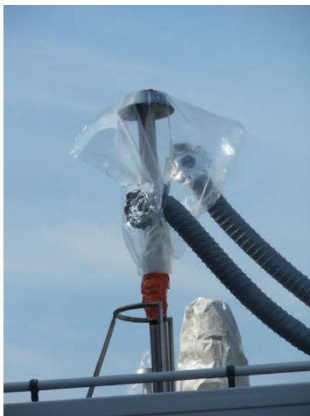
Figure 30 : Vue d'une tête de prélèvement coiffée d'un sac Tedlar muni de lignes d'alimentation et de rejet de gaz.
