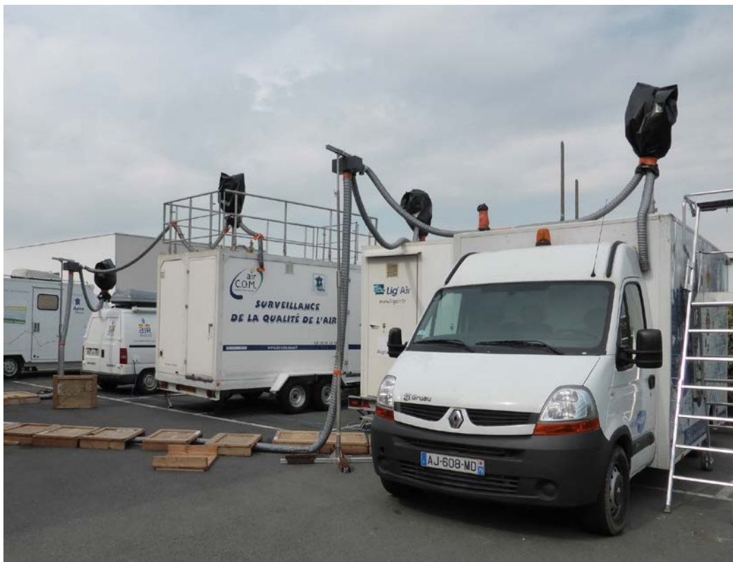
Figure 31 : Vue d'ensemble des moyens mobiles alimentés en gaz au niveau des têtes de prélèvements
