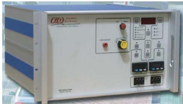
Figure 9 : Photographie du MA100-Methanalyser commercialisé par la société Alpha-Omega Power Technologies
