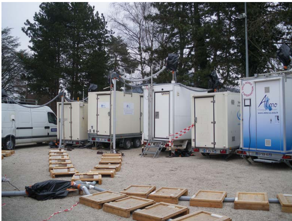
Figure 28 : Vue d'ensemble des moyens mobiles alimentés en gaz au niveau des têtes de prélèvements
