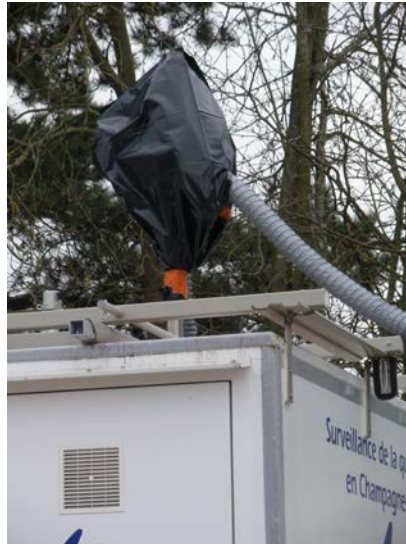
Figure 27 : Vue d'une tête de prélèvement coiffée d'un sac Tedlar recouvert d'occultant
