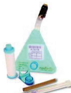
Figure 4 : Cartouche Radiello code 130, corps diffusif blanc code 120 et support de prélèvement
