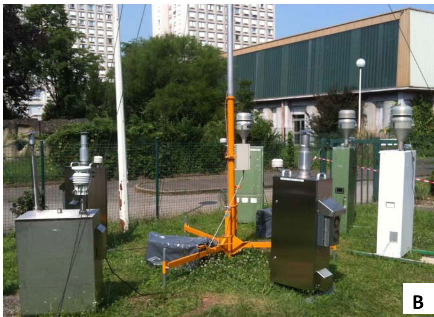
Figures 1a et b : Photos du site d'étude et des systèmes de prélèvement haut débit DA-80 mis en œuvre à l'extérieur et dans la remorque climatisée INERIS.
