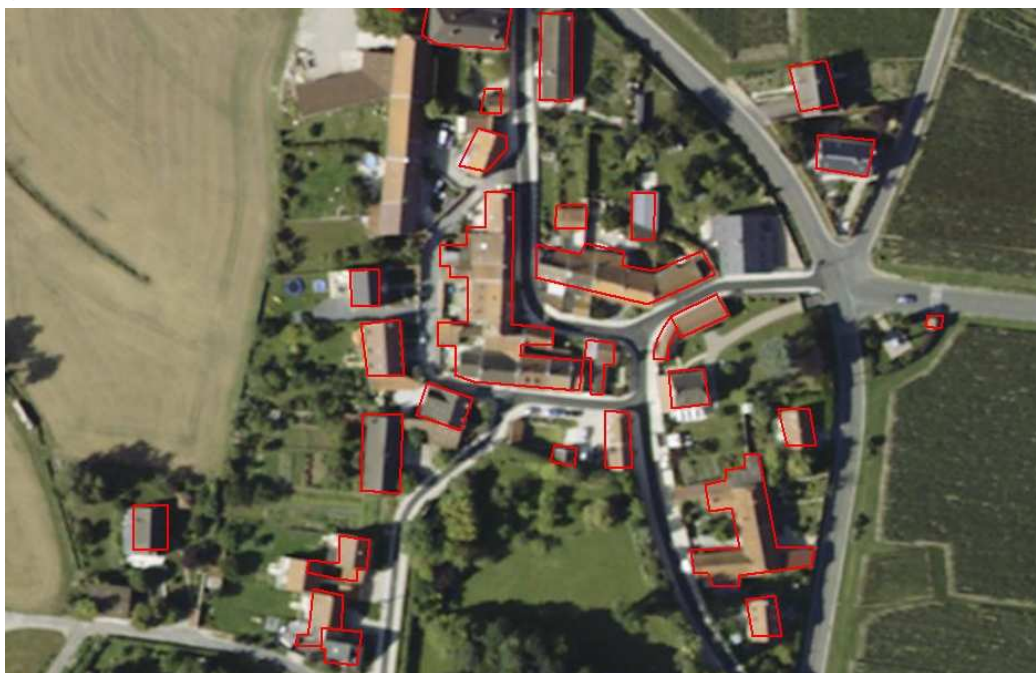
Figure 26 : agrégat de bâtiments dans la BD Topo
