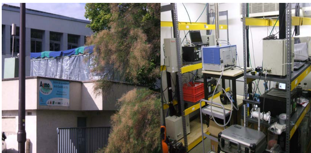
Figure 1 : Vue extérieure de la station de La Faïencerie de CREIL (60) ainsi que sur les analyseurs de particules PM mis en place pour les essais.
