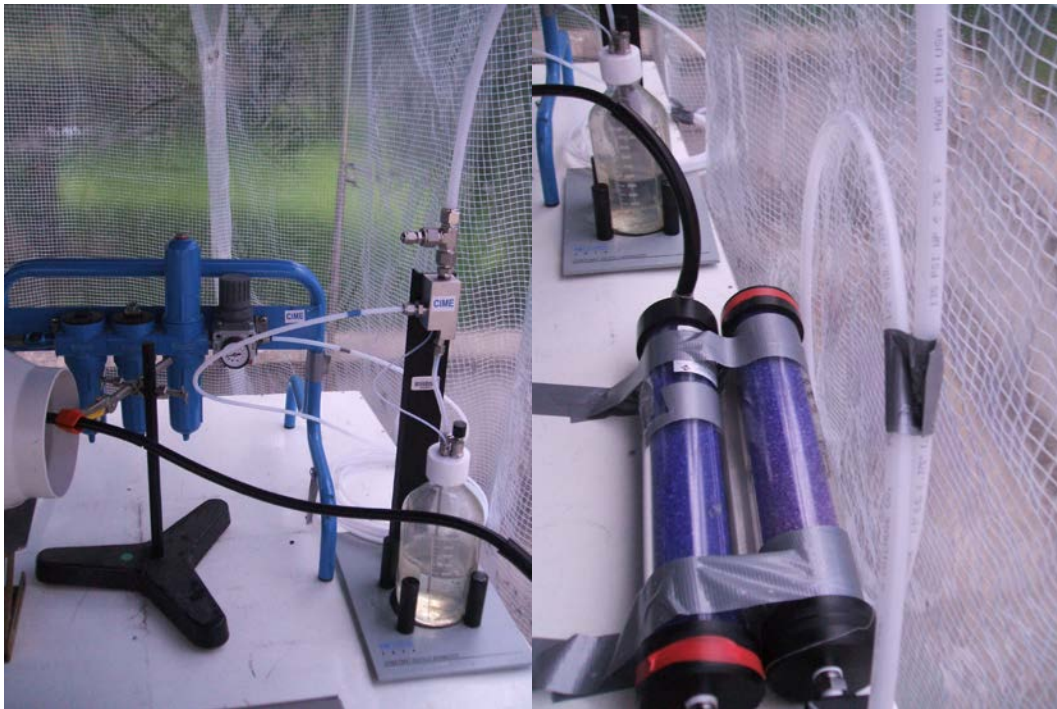
Figure 4 : vue du nébuliseur 3076 avec l'aérosol nébulisé séché par deux dessiccateurs en ligne avant d'être injecté dans le système de distribution via le ventilateur
