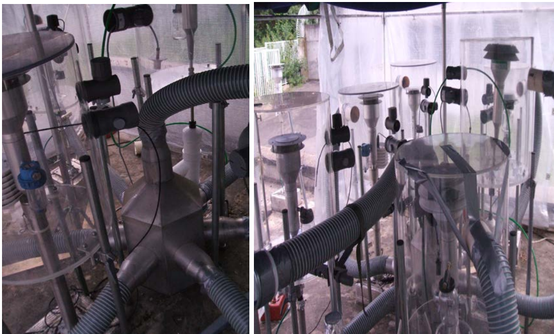
Figure 2 : vue du distributeur et de cloches de dopage.
