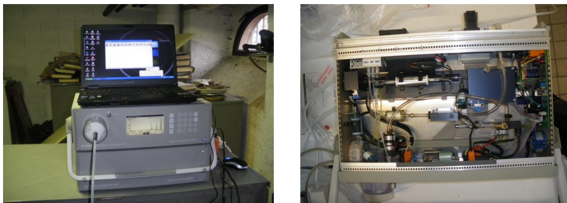
Figure 5 : Vues de l'analyseur UT3000 et son unité de calibration automatique
