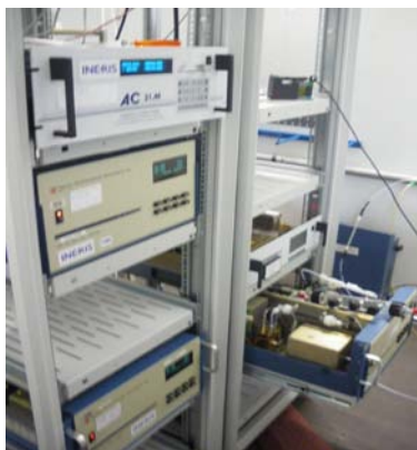
Figure 3 : Vue des analyseurs dans l'enceinte climatique
