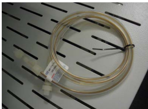
Figure 4 : Vue d'un sécheur échantillon usagé
