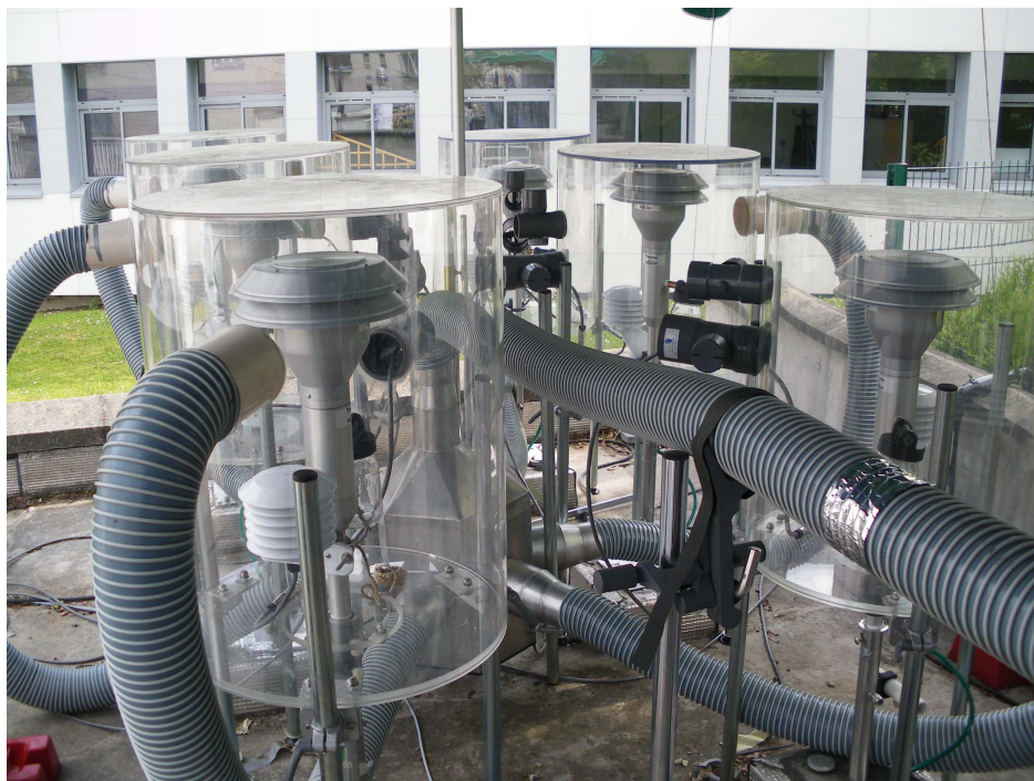
Figure 2 : Vue du dispositif de coiffage permettant le dopage en particules
