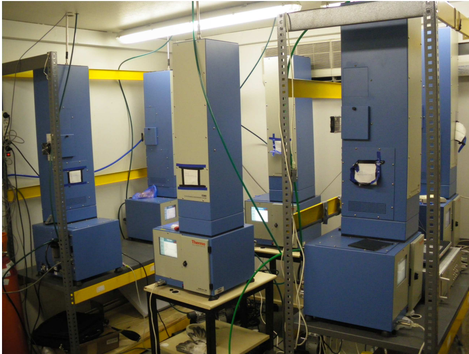
Figure 1 : Vue des TEOM FDMS 1405F installés dans la station
