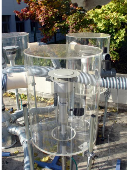
Figure 1 : Tête PM_{10} sous coiffe de dopage
