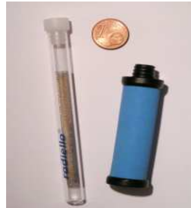
Figure 2 : Photographie d'une cartouche Radiello® code 165 (gauche) et du corps diffusif dans lequel elle doit être introduite pour le prélèvement (droite).
