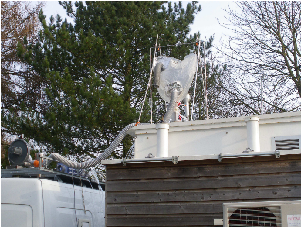
Figure 3 : Tête de prélèvement équipée en vue des dopages
