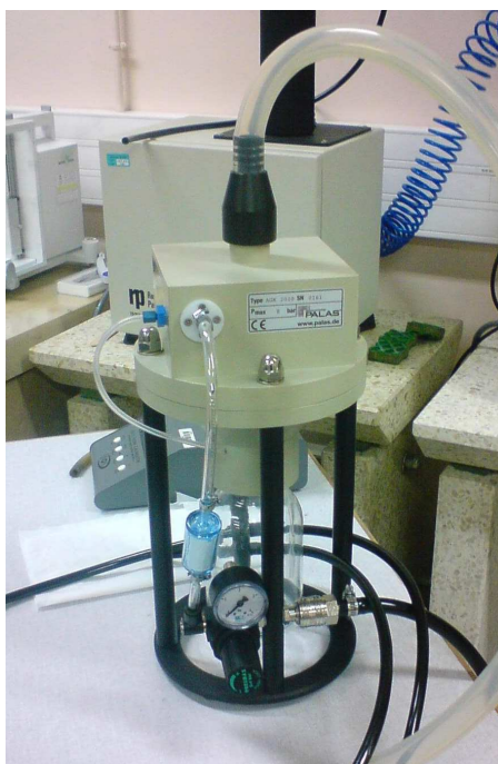
Figure 4 : Photo du générateur AGK 2000 (PALAS)
