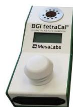
➤ Enregistrement de paramètres opérationnels : débit,  $T_{\text{amb}}$ ,  $P_{\text{amb}}$ ,  $T_{\text{tube}}$ ,  $T_{\text{case}}$ ,  $\Delta P_{\text{filtre}}$
