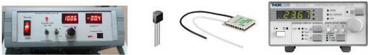
Figure 11 : a) Contrôleur de courant ; b) capteur de température ; c) module Peltier ; d) contrôleur de température
