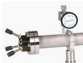
Figure 23 : Photo de la cavité optique mettant en avant la distance entre l'entrée/sortie du gaz et les miroirs
