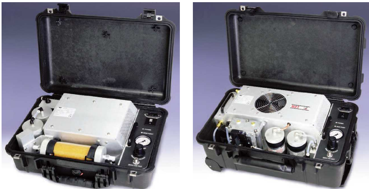
Figures 13 & 14 : Générateur portable d'air zéro modèle 751 (à gauche) et 751H (à droite) d'API
