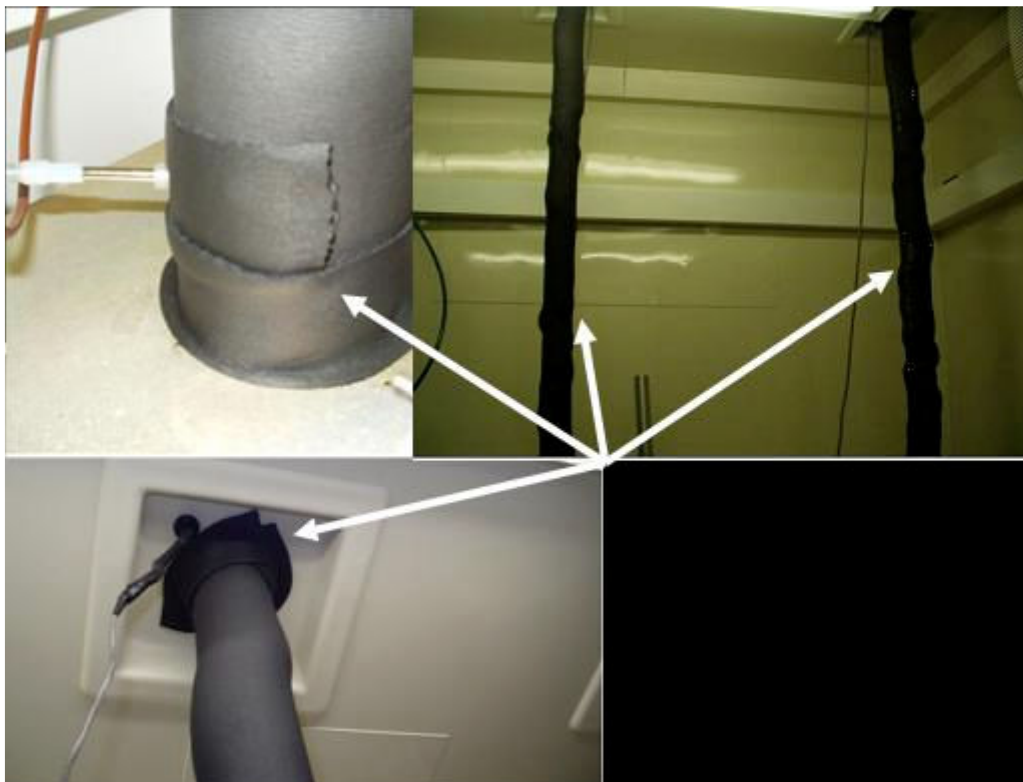
Photos 6.a : isolation thermique des lignes de prélèvement
