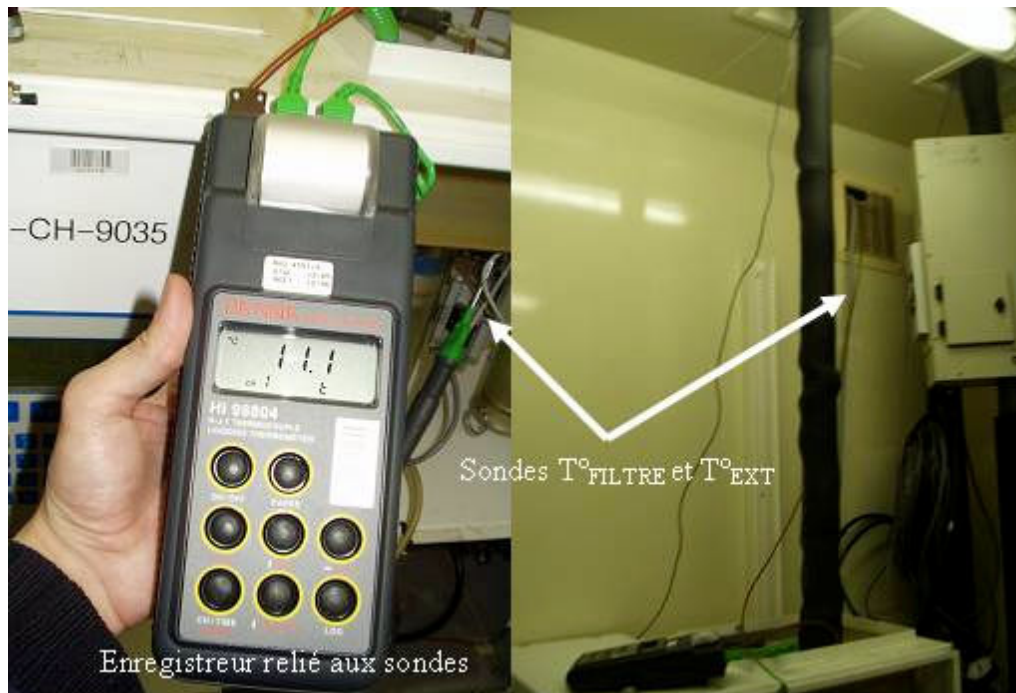
Photos 6.b : Enregistrement de données quart horaires des sondes T^{\circ}_{EXT} et T^{\circ}_{FILTRE}
