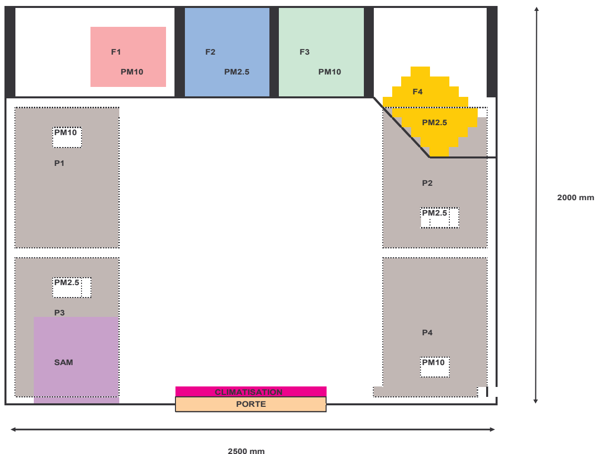
Schéma 4.a : disposition des appareils à l'intérieur de la cabine
