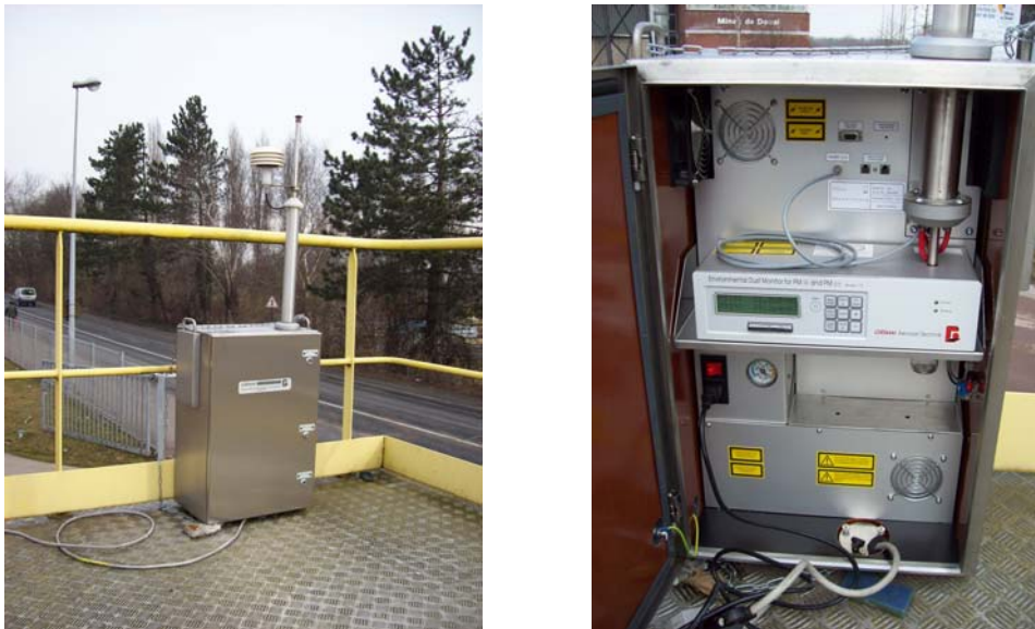
Figure 5: L'appareil GRIMM G365 sur le site de mesure de l'EMD (intérieur & extérieur)
