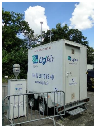
Figure 1 : Station mobile de surveillance installée à Saint-Jean-de-la-Ruelle
